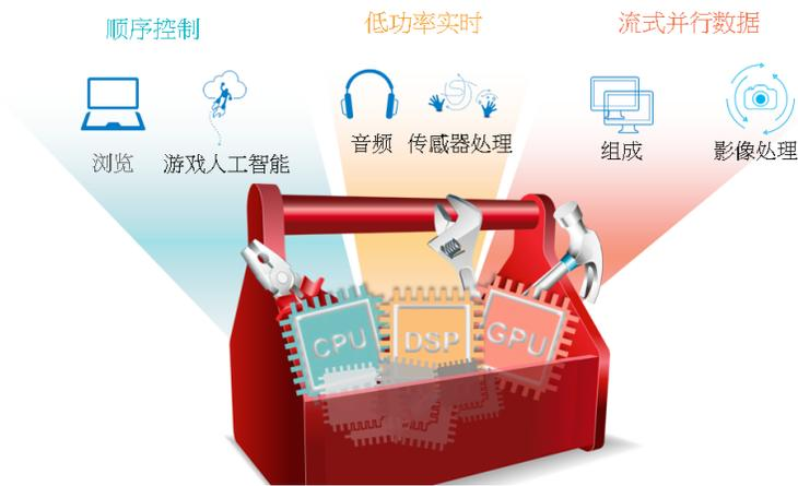
体现这项原则益处的其他典型示例是 Snapdragon 传感器引擎，该引擎基于 Hexagon 数字信号处理器 (DSP)。DSP 是一种处理引擎，非常适合解决现代化智能手机或平板电脑的各种传感器在处理数据时所面临的独特挑战。Qualcomm Technologies 定制设计的 DSP 不仅功耗极低，可与共享系统资源更紧密地集成，还能提供从 DSP 到共享 DRAM 的直接通道。这条直接通道意味着，在进行传感器处理任务时不必唤醒 CPU，这不仅可降低电力消耗，还能使更多传感器永久开启，这对取得消费者体验的新突破性进展至关重要。随着移动设备的更新换代，传感器和其他专门硬件的数量日益增加，这些类型的硬件效率将成为维持电池长久寿命的关键所在。
