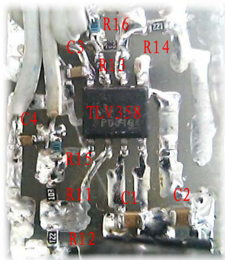
图 3-15 基于 LMV358 两个通道的放大检波电路实物图
