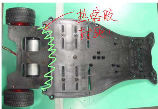
图 4-3 使用热熔胶固定电机支架与车模底盘
